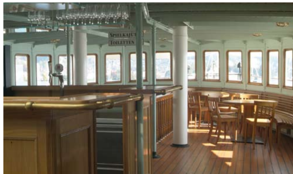
Die neue Theke, die neue Möblierung und die holzsichtigen Fenster in der Rotonde
